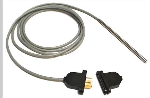
Le SP1000I SOCAPEX est une sonde de température PT100 4 fils munie d'un connecteur SOCAPEX raccordé au transmetteur TRT100. Celle-ci délivre une information électrique en fonction de la température à laquelle est soumis son élément de mesure.
