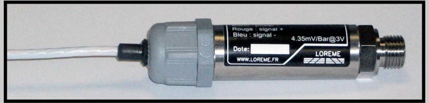
Le PR21 est un capteur de pression passif, type pont de jauge, de grande sensibilité pour les applications très faible consommation. Raccordé au transmetteur TRT100, celui-ci délivre une information électrique en fonction de la pression à laquelle est soumise sa cellule de mesure.
