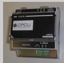
Le convertisseur CCN70 est dédié à la mesure de courant issue d'un débitmètre à sortie 4-20 mA et dispose d'une entrée tout ou rien permettant de retransmettre le sens de la mesure de débit. Raccordé au transmetteur TRT100 à l'emplacement initial du CDV20, le CCN70 transmet ses mesures par l'intermédiaire d'une ligne numérique.
